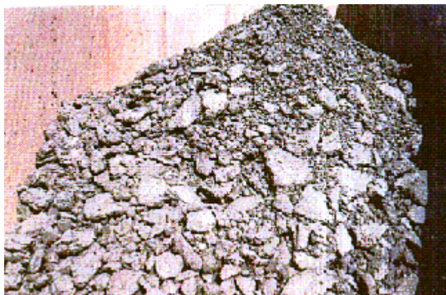
Bild 1: Klärschlamm mit dem Hydrosort-Verfahren entwässert
